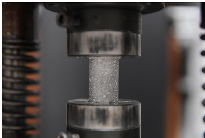
1. ábra – A fárasztóvizsgálat mérési elrendezése
